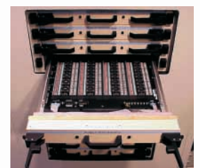
Fig. 2: Individual DUT tray
